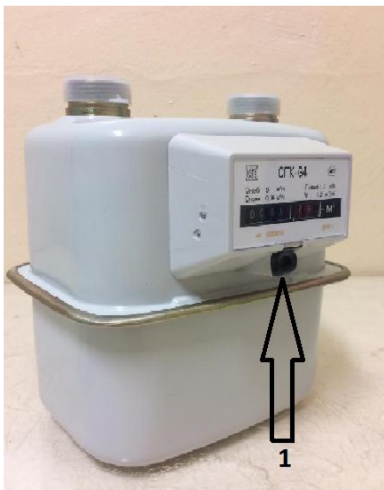
Рисунок 2– Схема пломбировки от несанкционированного доступа и обозначения места нанесения знака поверки (1) счетчиков газа камерных СГК-G
